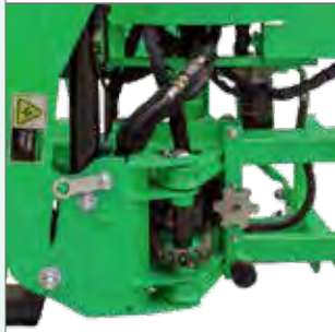
Spostamento laterale manuale Manual side shift
